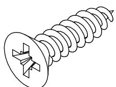
$\varnothing 3,5 \times 16 \text{ mm}$
