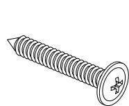
$\varnothing 4 \times 30 \text{ mm}$
