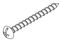
$\varnothing 4 \times 50\text{mm}$
